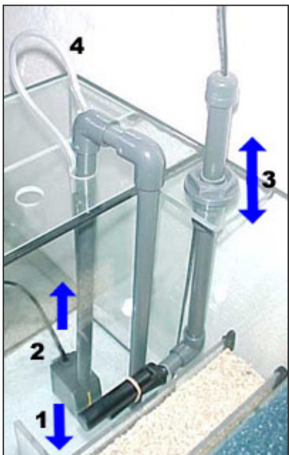
Quando l'acqua nella sump si abbassa (1) l'interruttore galleggiante regolabile in altezza (3) dà il consenso alla pompa (2) finché il livello non viene ripristinato.
