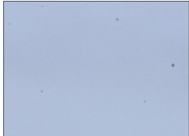
File digitale ingrandito del 100% - I punti neri corrispondono a polvere ed altri detriti depositati sul sensore
