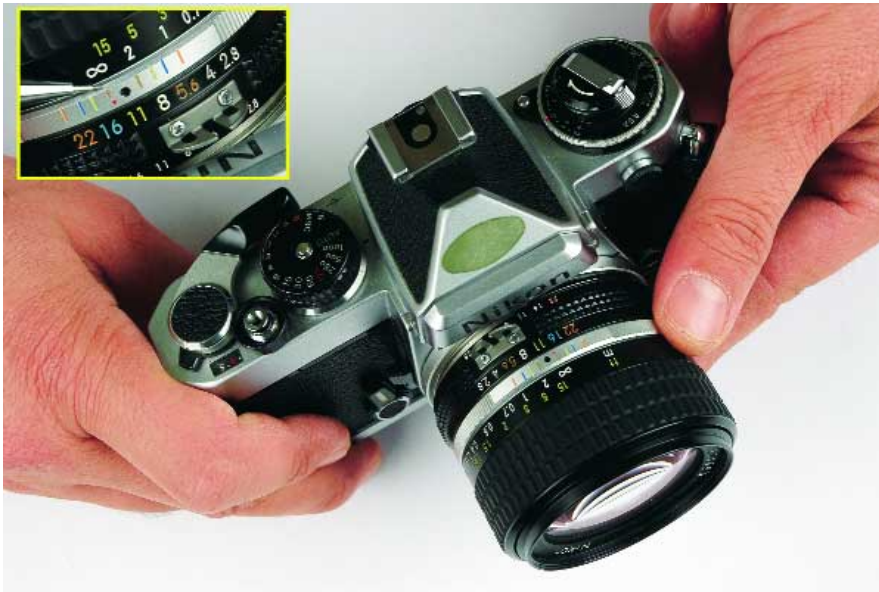
La Nikon FE usata per realizzare le immagini dell'articolo con il 28mm f/2.8 AIS ottimizzato per le brevi distanze. Nel riquadro è possibile notare che il diaframma impostato è f/11 e la messa a fuoco sull'infinito in corrispondenza del riferimento rosso IR presente su molti obiettivi, tra cui tutte le ottiche Nikon AIS.
